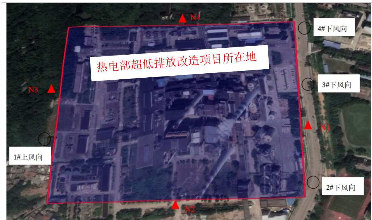
图 6-2 无组织废气、厂界环境噪声监测点位示意图
