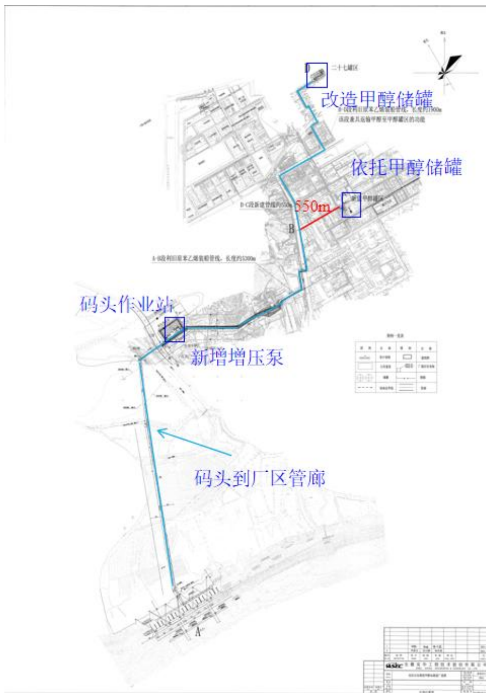
图 3.1-1 安庆石化码头—厂区管廊走向示意图
