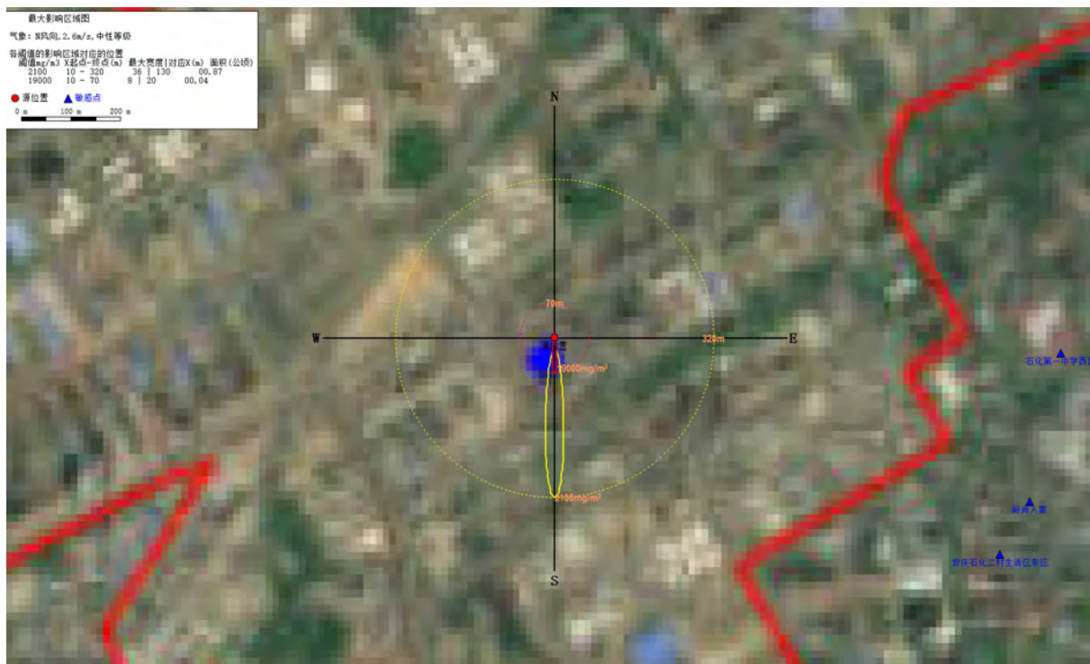
图 7.7-1 异丁烷泄漏事故预测图（最不利气象条件）
