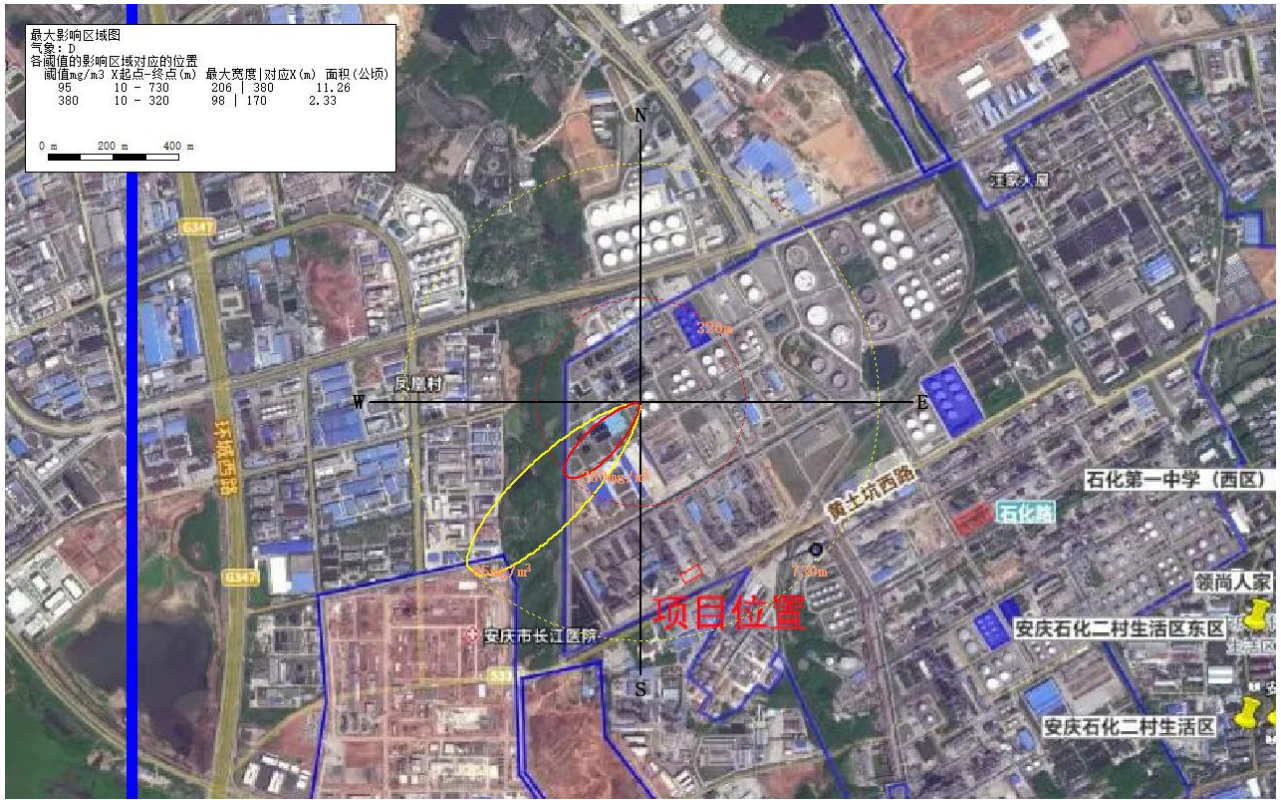
图 7.3.8-2 最常见气象条件下事故状况下风向 CO 最大影响范围示意图
