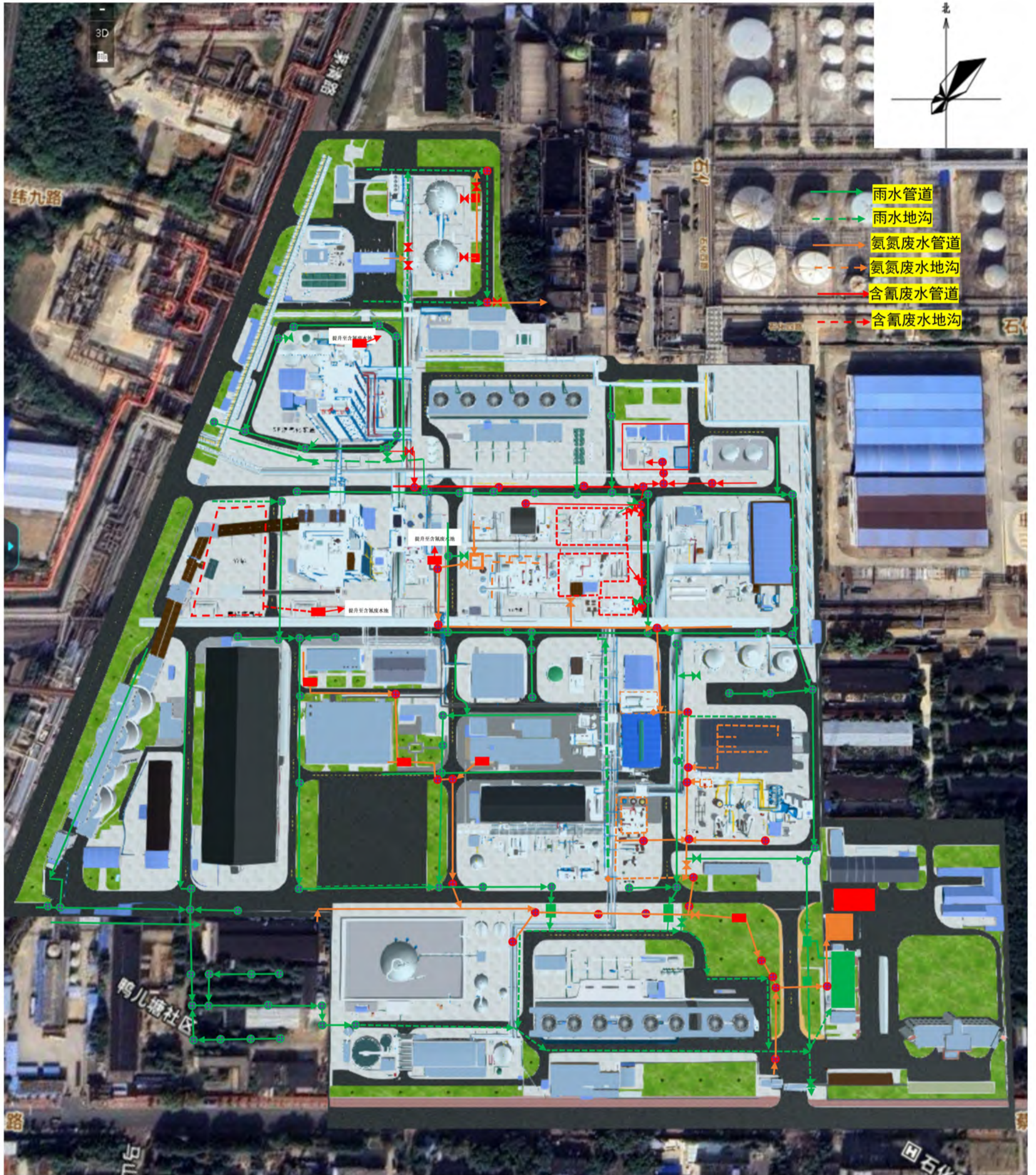
图 3.1-3 本项目厂区雨污水管网图
